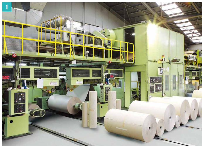
①甲府工場のISOWA社製コルゲーターマシン。非常に高温になります。
