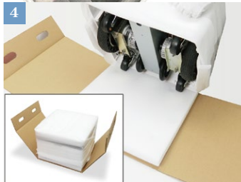
①自律移動ロボット【KeiganALI(ケイガンアリ)】。 ②従来の梱包はアルミケース+ウレタンを使用されていました。 ③初期のご提案では、積層ダンボールを用いての緩衝設計を検討いたしました。 ④商品の重量と紙の強度、コスト面を考え、最終では底面にウレタン+ダンボールで梱包することになりました。
