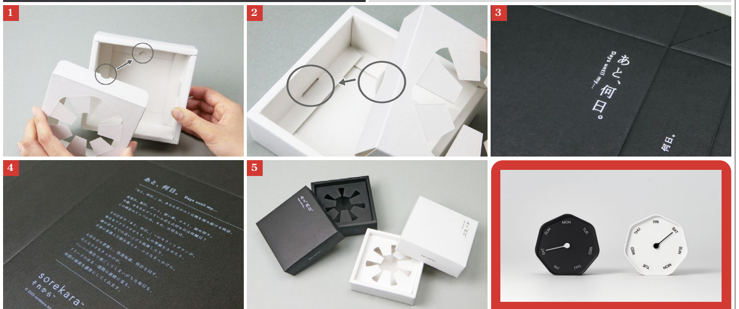
①パーツには、組み合わせる方向がすぐわかるように半円の切込みが入っています。②仕切りパーツは箱の中で動かないように左右の底にはめ込んで固定。③フタ天面 ブラックブラック両面310g箔押し白1色。④身箱底面 ブラックブラック両面310gオフセット白1色印刷。⑤時計パッケージを黒・白と2種類ご依頼いただきました。
