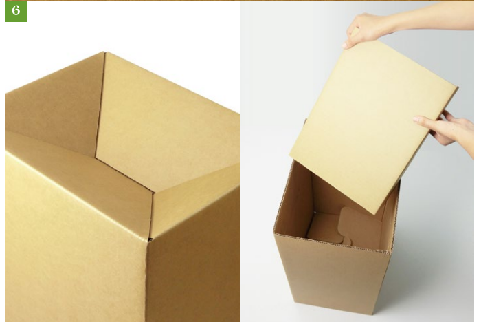
⑤回収BOXのダンボール表面には、撥水ライナーを使用しています。 ⑥底面は凹んでいます。ダンボールの断面から水を浸透させない為です。内側には底パットをセットします。
